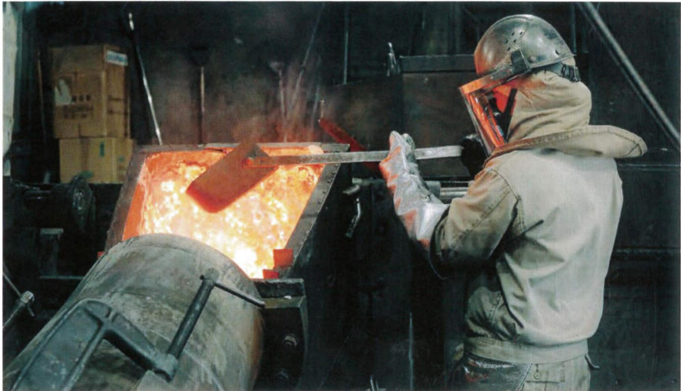
溶かした銅合金を鋳型に流し込んでいる様子。中小企業の場合、鋳造、鍛造、加工などいすれかの工程に特化した企業が多いものだが、大和合金、三芳合金工業では全工程を一貫して行えるのが強みだ
