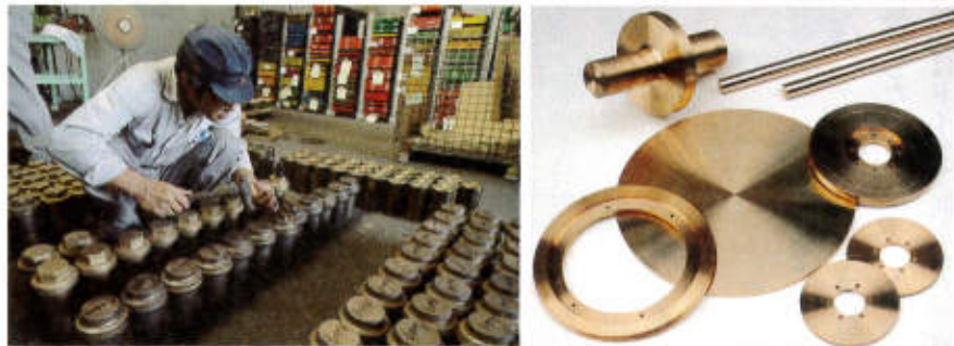
溶解・鋳造から素材検査までの一貫生産を行うことで少量多品種生産が可能になる。超短期納品の依頼にも対応。三芳合金工業本社工場内の熱処理工程（上）、素材検査（左下）と独自技術で開発したクロム銅製品（右下）。
