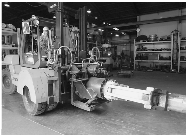
三芳合金工業に配備したマニユプレーター
