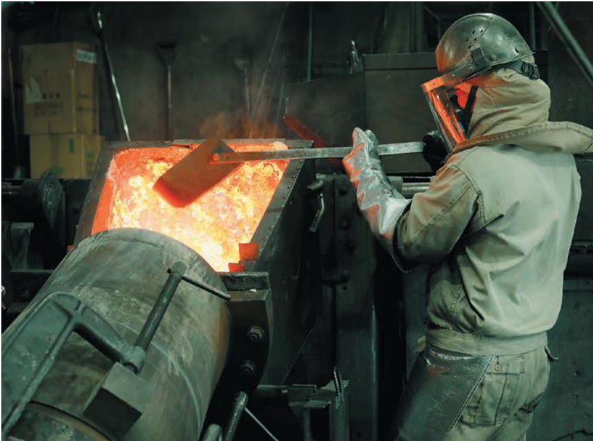
1200℃を超える特殊銅合金の溶湯を、金型へ鑄造する
