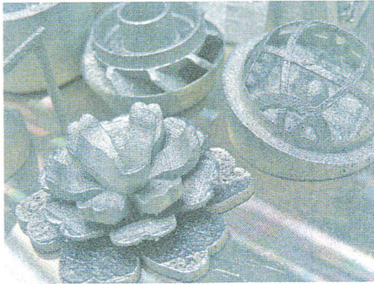
研究中の銅合金粉末を使った3Dプリンタによる積層造形品
