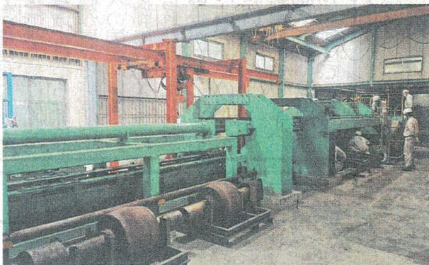
導入したマンネスマン穿孔機は古河電気工業の旧大阪伸銅所(兵庫県尼崎市)で長年稼働。昨年、古河電工から別会社へ事業譲渡されたが、コロナ禍で工場自体の閉鎖が決まり、三芳合金が穿孔機のみ譲り受けた。同社によるとフレームや減速機、ロールなど本体は100年以上使われており、国内で稼働する非鉄専用マンネスマン穿孔機は他に1機のみだという。
