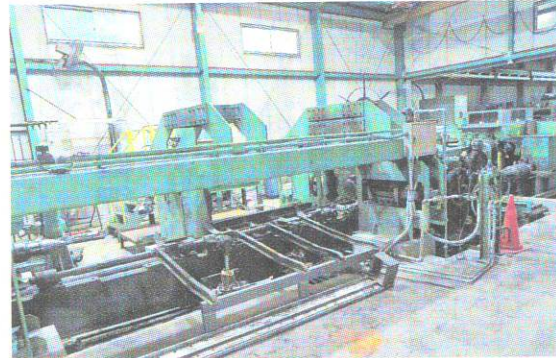
パイプ形状の太物材料製造に用いる熱間穿孔機
