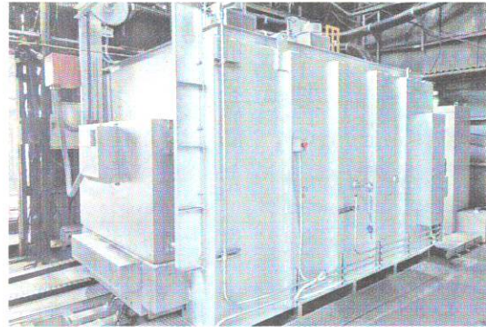
8月に稼働した新熱処理炉
